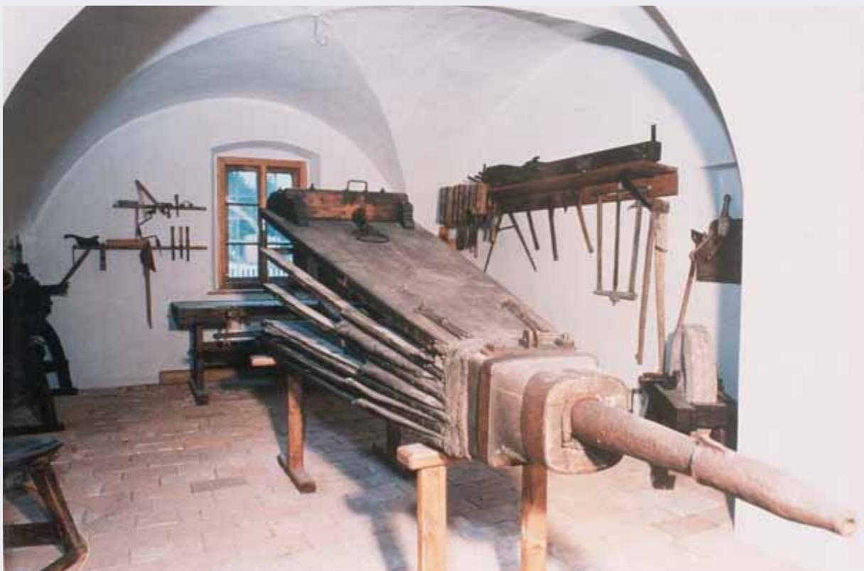
Als Gebläse für die Essen dienten mittels Wasserrad angetriebene Blasbälge. Im Blagsetzerhaus in Weyer wurden Blasbälge hergestellt und repariert.
